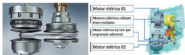
Figura 4. Transmissão CVT convencional e transmissão e-CVT. Fonte: Autoentusiastas / Toyota.
